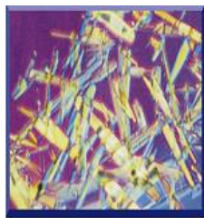
Figuur 2: driedimensionale voorstelling van paraffinewaskristallen met toevoeging van Cold Flow Improver QC
